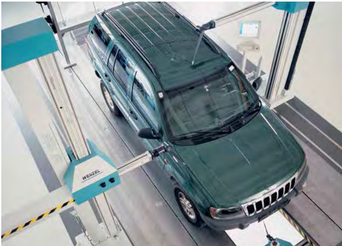
Horizontalarm-Messgeräte bieten optimalen Zugang von allen Seiten, beispielsweise bei der Messung von Karosserien.
